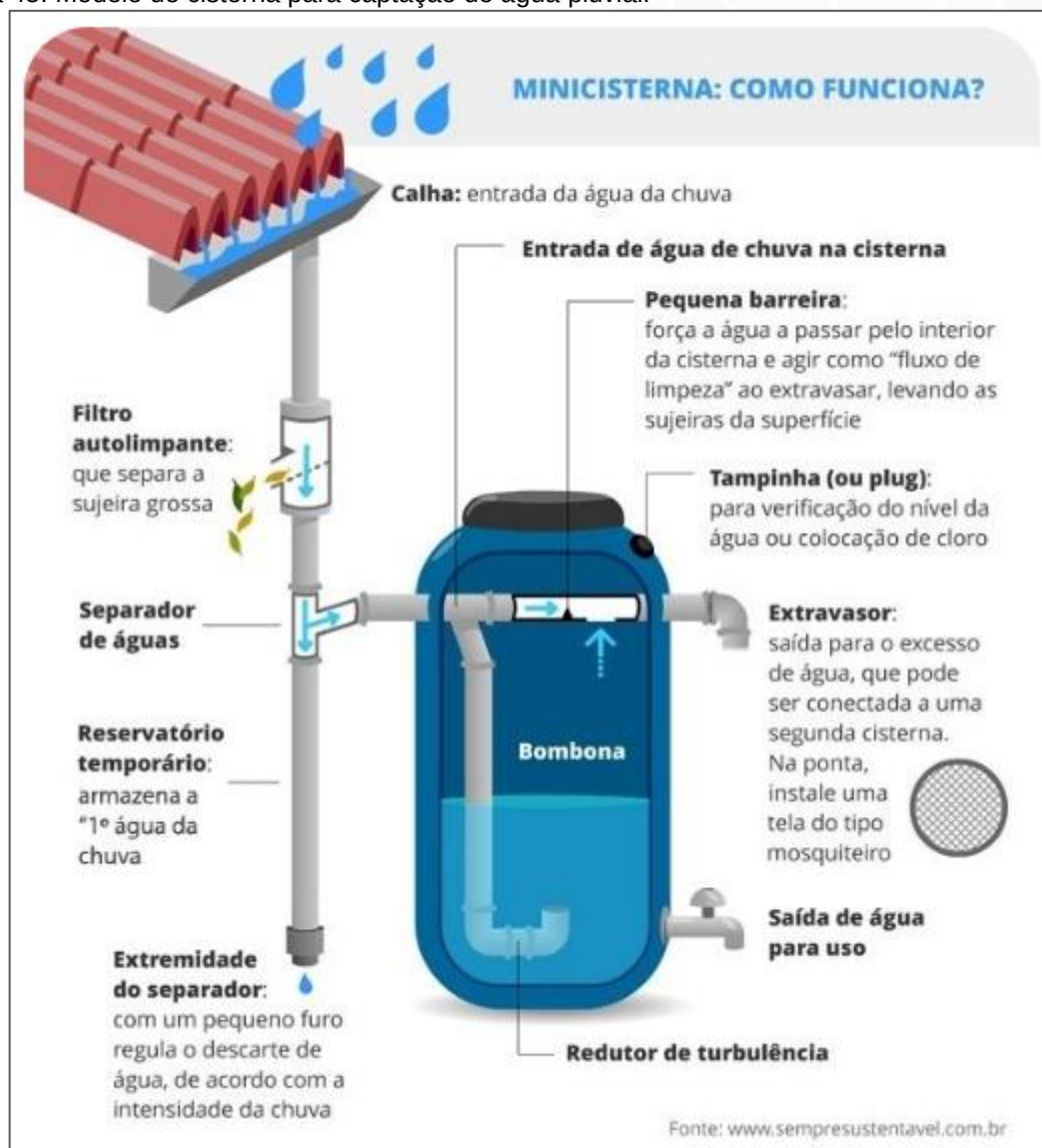
Figura 45: Modelo de cisterna para captação de água pluvial.
